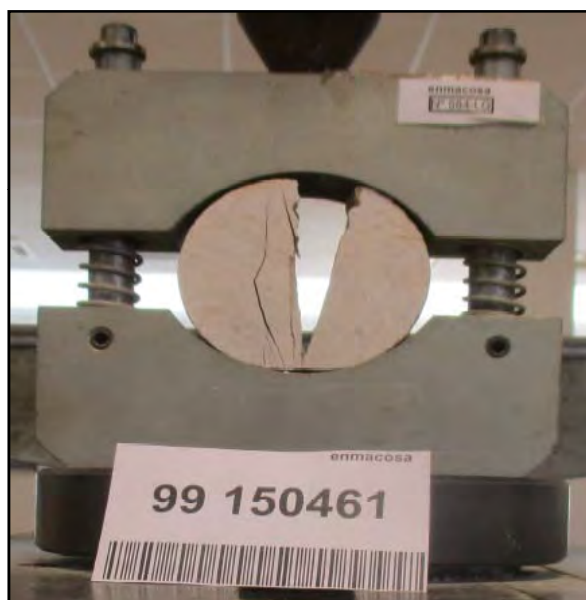
Foto N°1 Vista del testigo después de la rotura
