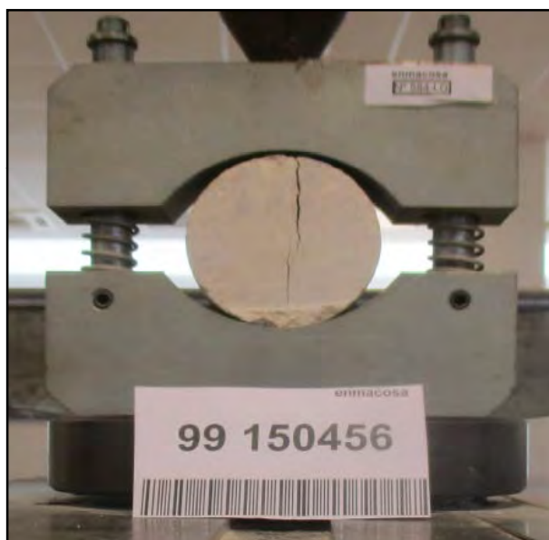
Foto N°1 Vista del testigo después de la rotura
